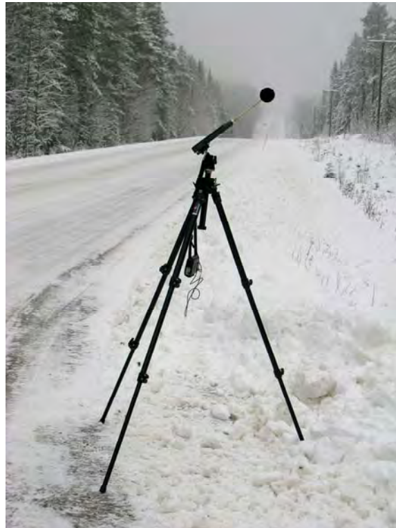
Kuva 11. Ampumaharjoituksen aiheuttaman melun mittausta kantatien 89 varrella marraskuussa 2007.
